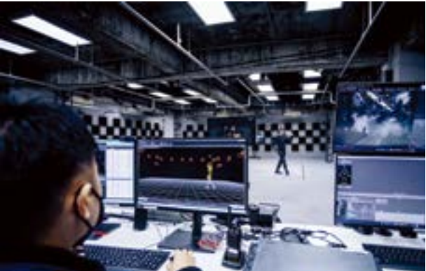
The One Academy 动作捕捉工作室备有 Sony PlayStation 最先进的动作捕捉设施，装有 32 台 VICON 摄像机及实时显示屏，可实时捕捉身体动作和面部表情。这技术广泛应用于电影、动画和电玩游戏开发行业。
